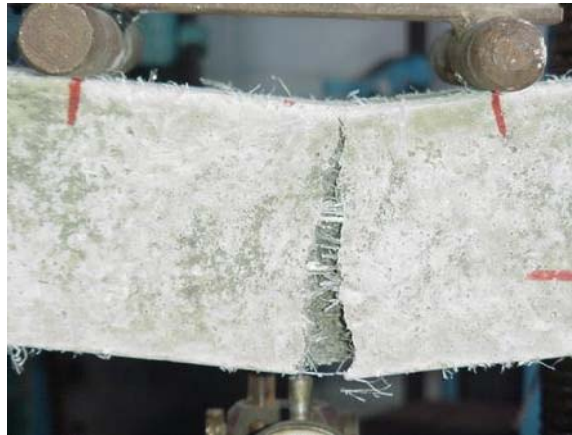
Figura 3: Probeta de mortero reforzado con fibras de sisal ensayado a la flexión.
