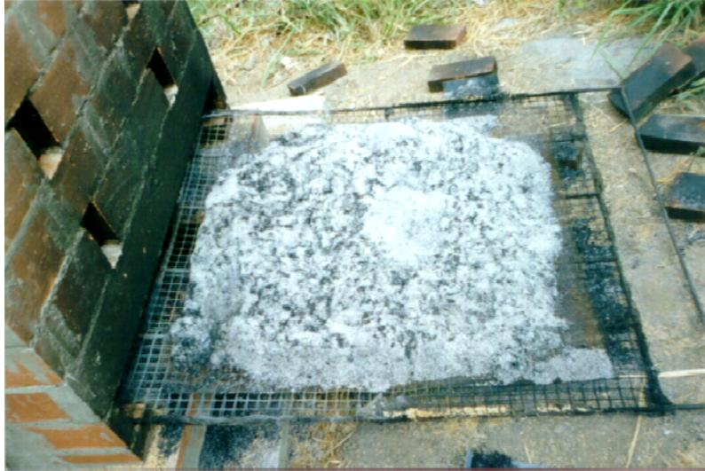
**Figura 1:** Ceniza de cascarilla de arroz a la salida del horno. (Elaboración propia).
