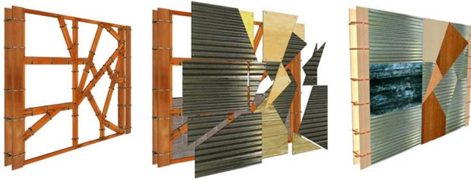
**Figura 3:** A la izquierda el bastidor estructural con los encofrados para los machones y la trama interior. En el centro los fragmentos de los materiales y los bloques antes de instalarse. A la derecha, el panel una vez finalizada la instalación de los materiales. (Imágenes tridimensionales elaboradas por David Arana, 2011)
