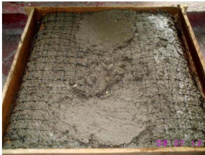
Figura 6: Figura 6: Panel de mortero reforzado con mallas de plástico. Fotografía tomada por Solángel Mejía
