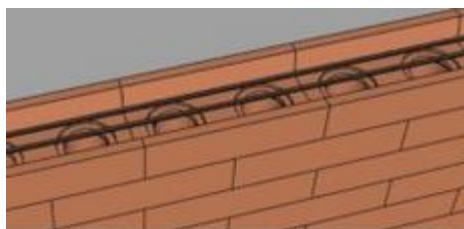
Figura 2. Detalle barras de acero en refuerzo horizontal, sistema constructivo Siconte Fuente: Basado en http://ecomaquinas.com.br/
