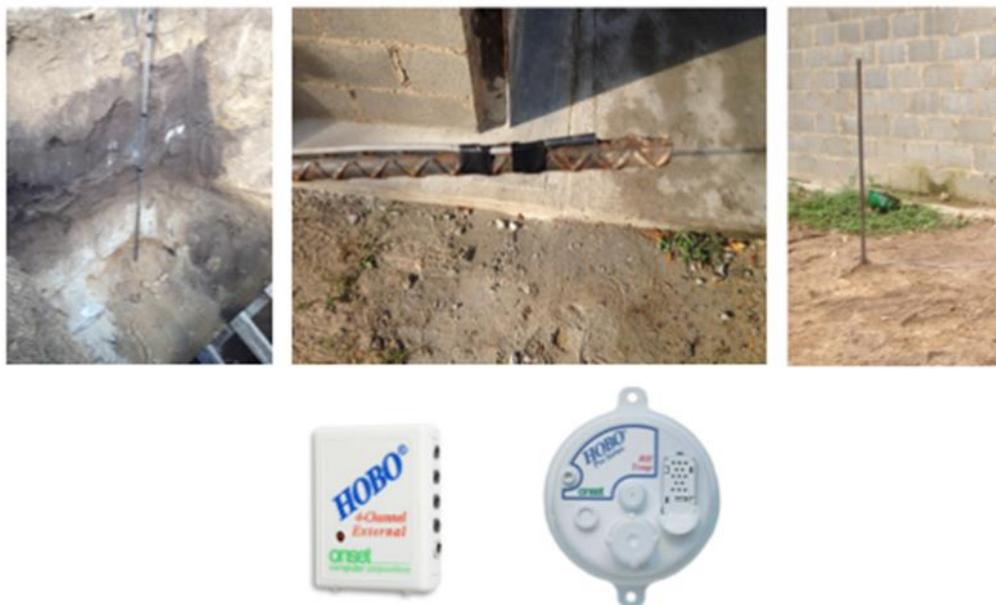
Figura 2. Proceso de excavación y colocación de los sensores para el registro de la temperatura del suelo.
