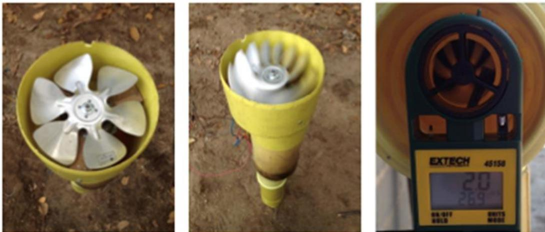
Figura 5. Instalación del ventilador y medición del aire dentro del tubo.
