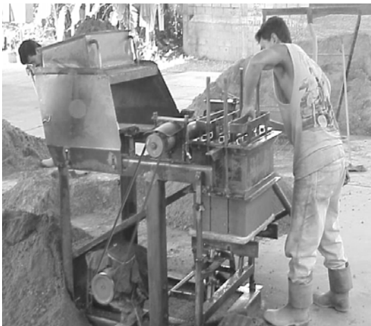
Fotos 1: Llenado de la mezcladora con los agregados y máquina vibrocompactadora. Archivo personal
