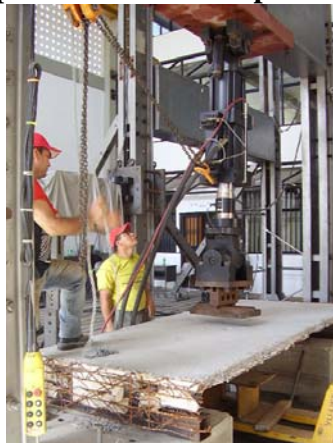
Figura 3. Aplicación de fuerza puntual sobre la losa.
