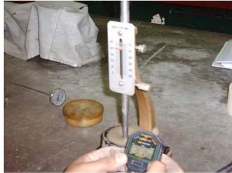
FIGURA N° 7. Ensayo de Consistencia.
