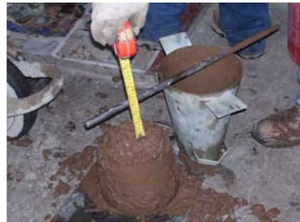
**FIGURA N° 11.** Medición del Asentamiento.
